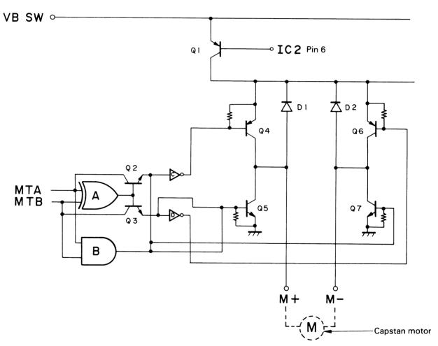
Fig. 3-5 Motor Drive IC Circuit
